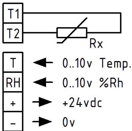
Монтаж, установку и подключение канального датчика влажности THS-02 рекомендуется производить после завершения всех строительных работ и после первичной продувки вентиляционной системы, чтобы исключить запыление фильтра.
